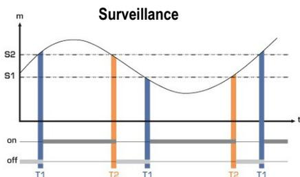
L'alarme se déclenche lorsque la mesure est en dehors du seuil haut et du seuil bas.
