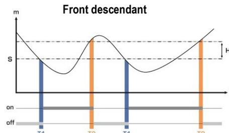
Mesure (m) < Seuil (S) pendant la temporisation T1 → Activation de l'alarme.
